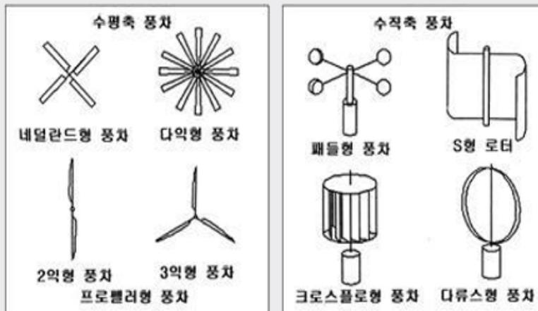
수직축 풍차는 마치 물레방아처럼 바람의 방향과 축의 방향이 수직인 풍차입니다. 이러한 풍차는 바람 방향으로 회전하기에 풍차의 한쪽이 바람 방향으로 움직이면 다른 한쪽은 바람을 거슬러 움직이는 대신 어느 방향으로 바람이 불어오든 회전할 수 있는데요, 이러한 풍차의 장점과 단점은 무엇일까요?
